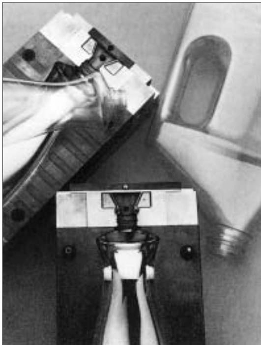
Zwei Hälften einer Blasform, die Einsätze aus Moldmax HH (Kupfer-Beryllium) enthält, mit denen der Halsteil einer Kunststoffflasche geformt wird.
