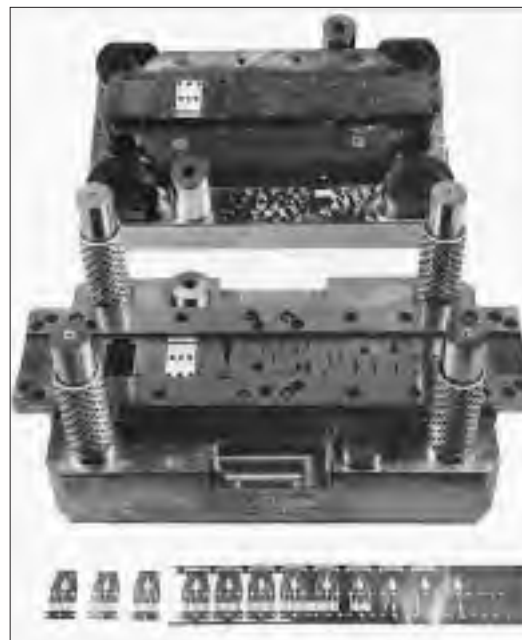
Folgeschnittwerkzeug gebaut aus Uddeholm Sverker 21. Langlebiges Werkzeug zum Stanzen von dünnen Teilen.
