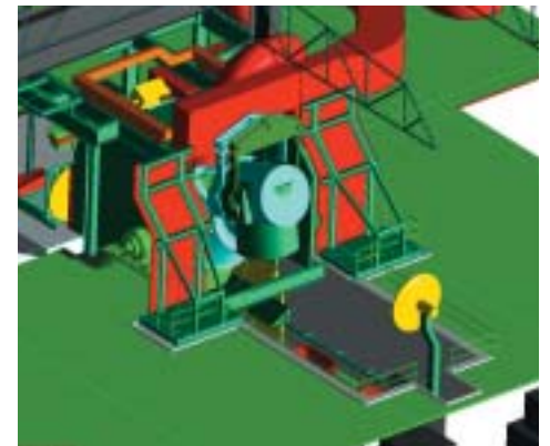
Der Converter wird bei geöffneter Dog-House-Tür mit flüssigem Stahl gefüllt.
