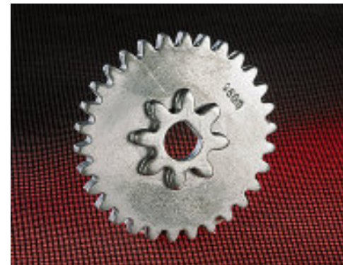
Zahnrad, kaltverformt und feingeschnitten, z. B. aus 16MnCr5
