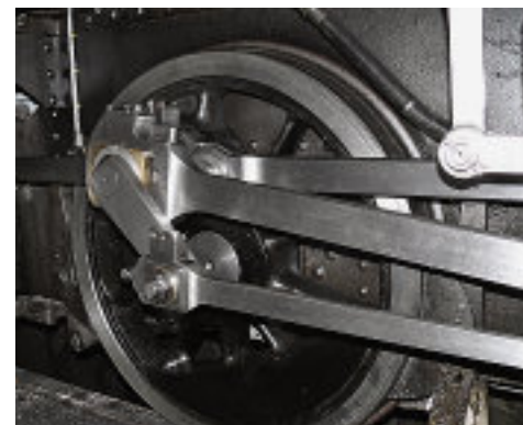
Kraftübertragung auf das Rad mit Gegenkurbel und Schwingenstange
