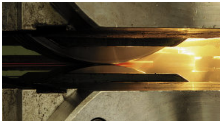
Contiwalzlinien für kleinere Profilquerschnitte mit engsten Toleranzwerten
