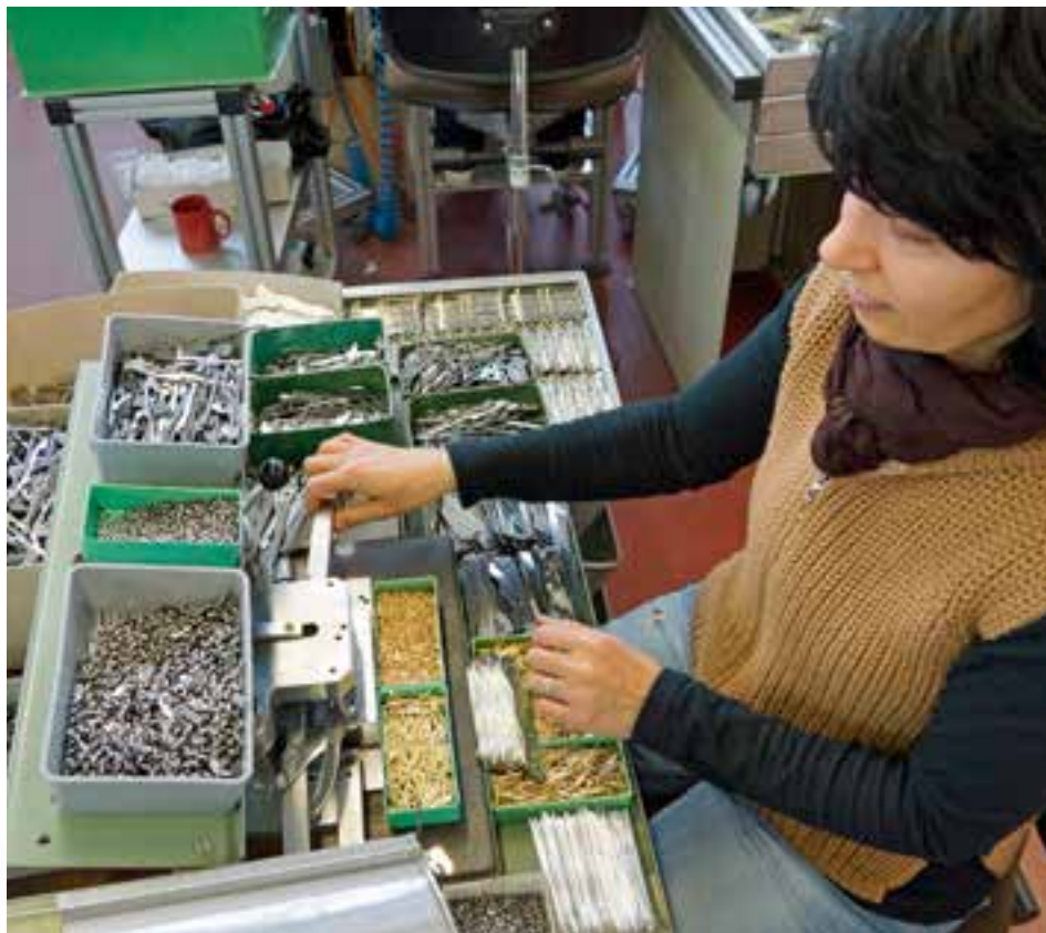
Das Zusammenstellen der Messer erfolgt nach wie vor in Handarbeit.
